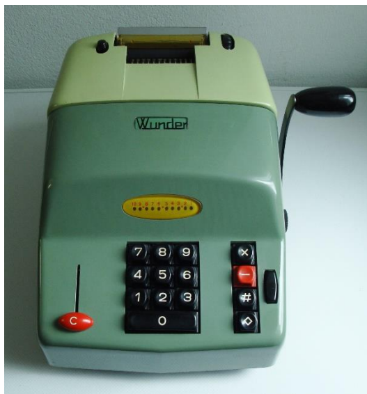
Abb. 3: Saldiermaschine Wunder, S/N 001.612, mit reduzierter Funktionstastatur, Rechenkapazität 10 x 11
