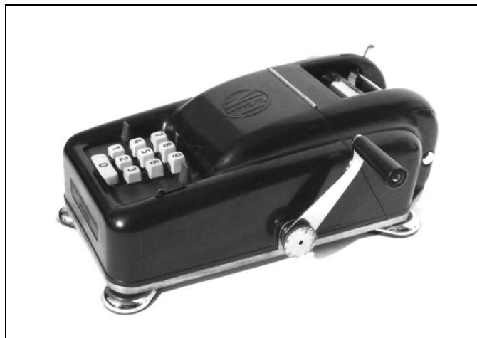
Abb. 10: Stromlinienformen im Rechenmaschinenbau: NFI-Modell 3A (hier Serien-Nr. 38233)
