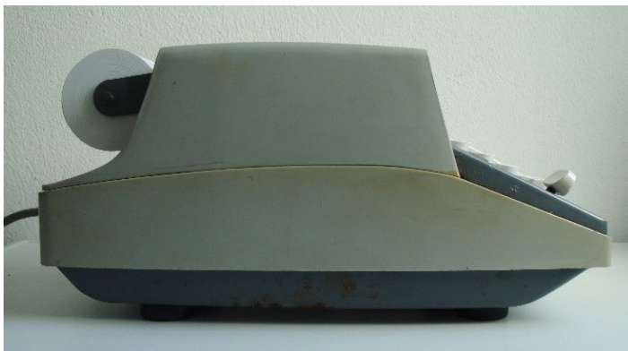
Abb. 15: Erste Gehäuseversion, Ricomac 201 mit abnehmbarem Gehäuse-Oberteil
